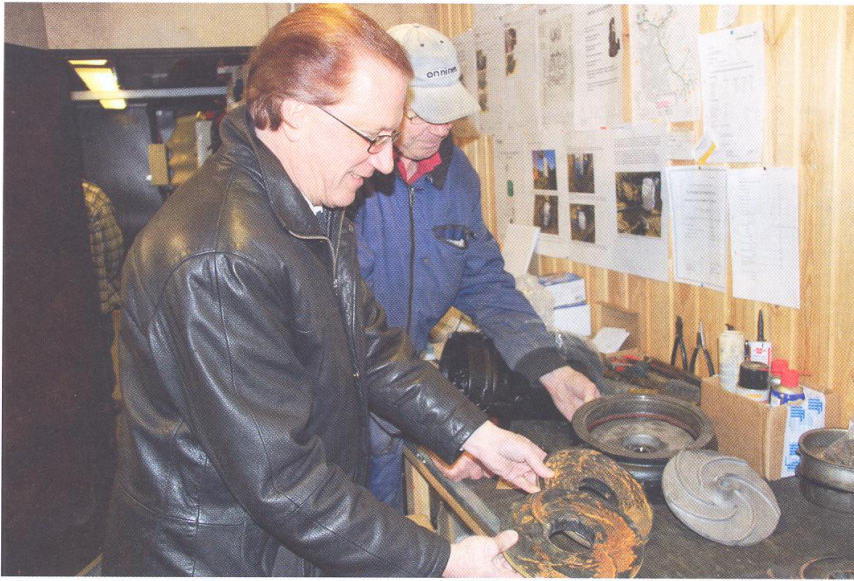
Hannu Javanainen ja Sakari Penttinen tutkivat kavitaation vaurioittamia pumppujen juoksupyöriä. Koiviston vesihuolto-osuuskunnan huoltotukikohtaan tuodaan korjausta ja huoltoa varten myös muiden osuuskuntien kalustoa. Penttinen on opastanut alueen osuuskuntia palvelevan yhtiön nuorempaa henkilöstöä verkostomestarin tehtävien hoidossa.
